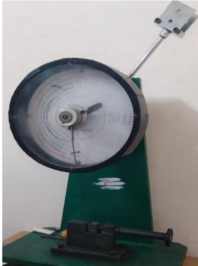
Fig 6.1 - ITM for Izod Test
